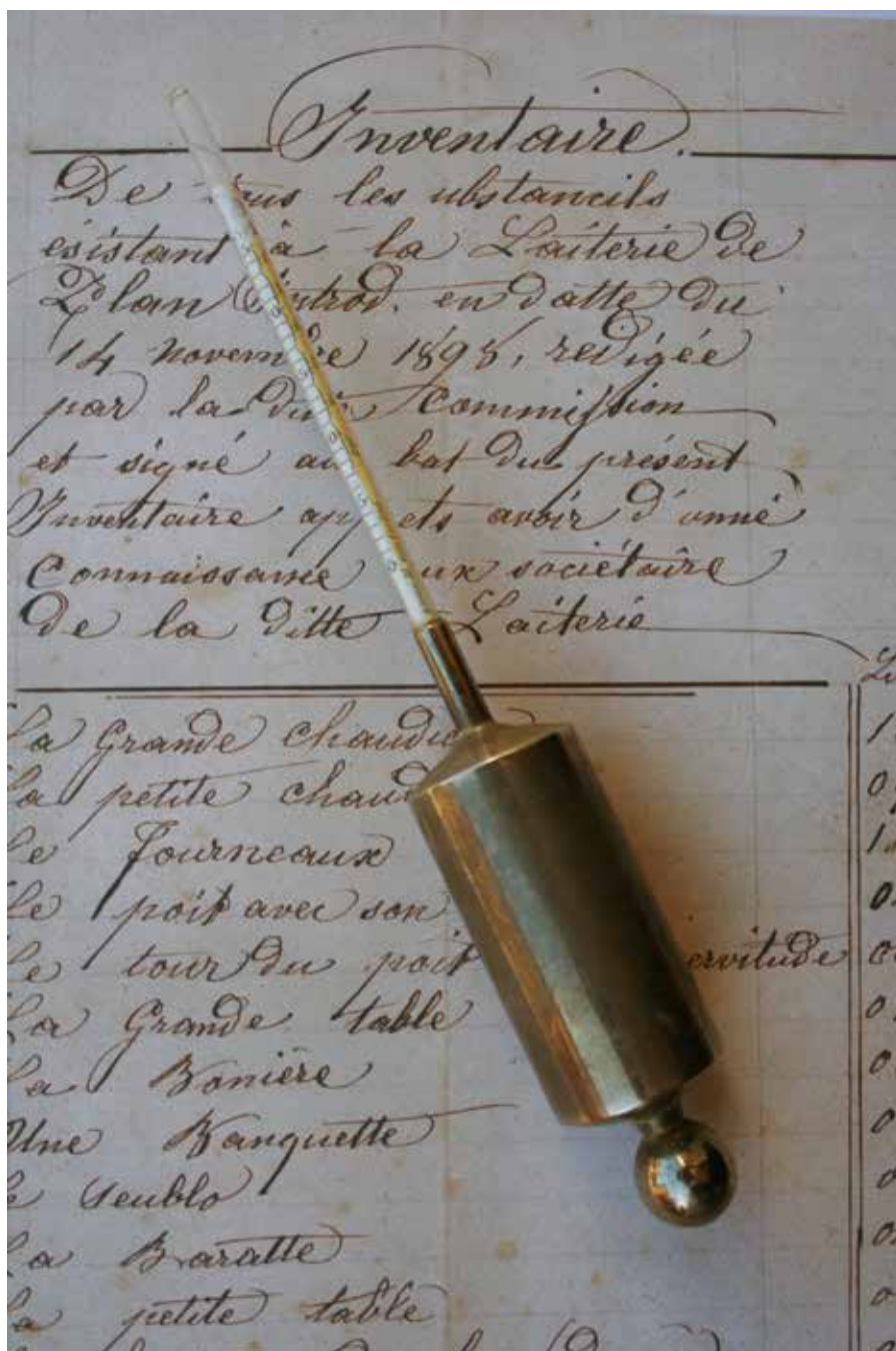
L'aréomètre utilisé par la commission pour effectuer les contrôles sur la qualité du lait – Archives de la laiterie
